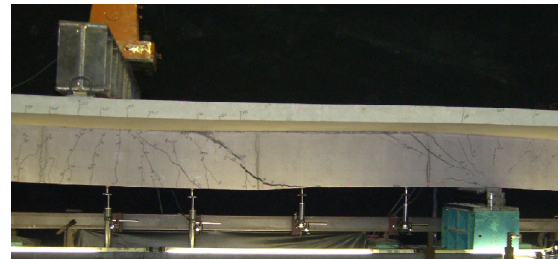
写真-1 破壊時のひび割れ状況の例（No. 3）
