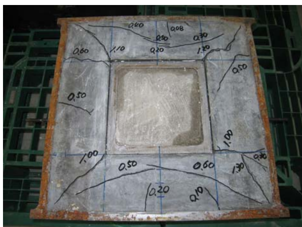
写真-1 ひび割れ状況 (Series II)
