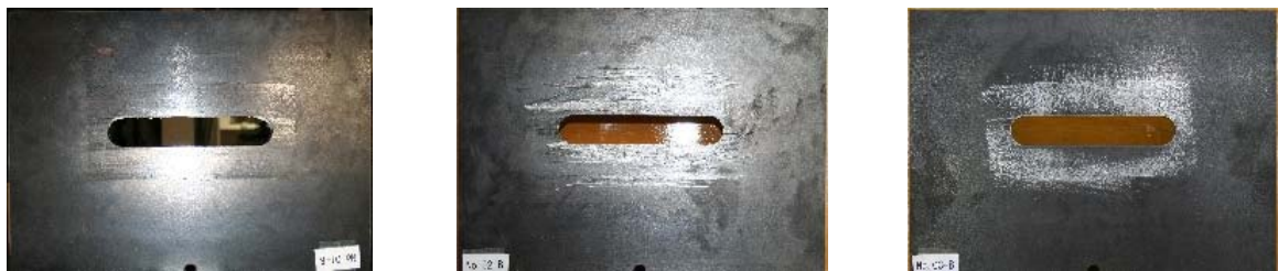
写真-2 実験1試験体の摩擦面2側T形金物の摩擦面(実験終了後)
