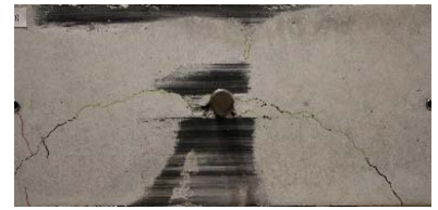
写真-3 CWD2-150mm試験体のコンクリート壁板の摩擦面(実験終了後)
