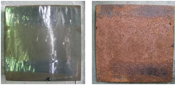
(a) グラインダー処理 (b) 赤錆処理 写真-1 鋼材（鋼製耐圧板）の表面処理状況
