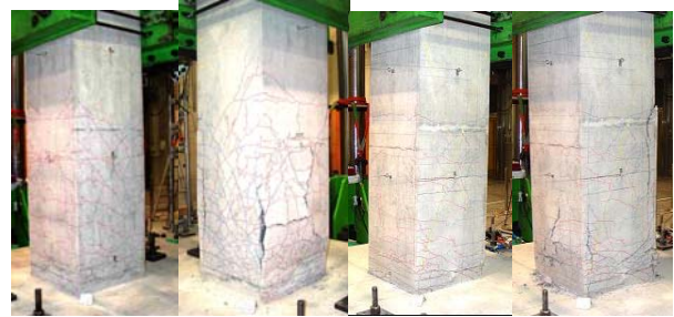
( P_{max} 時) ( P_y 低下時) ( P_{max} 時) ( P_y 低下時) (a) X20dana (b) X20danb 写真-2 損傷状況 (No. 2 シリーズ)
