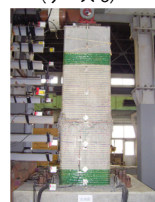
写真-2 ひびわれ状況写真
