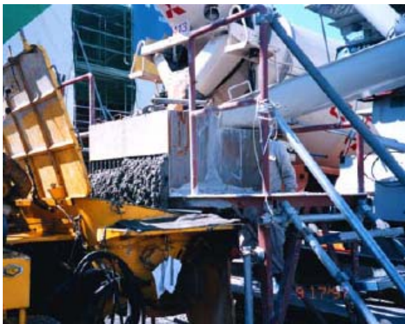
図4 自己充填性の全量試験装置
