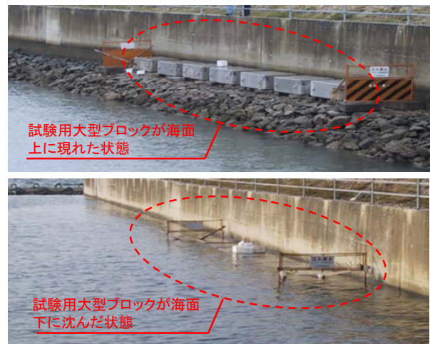
写真-1 試験用大型ブロックの曝露状況 (沿岸部干満帯 上:干潮時,下:満潮時)
