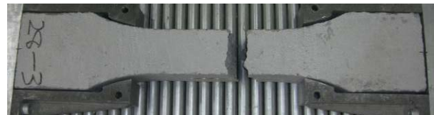
写真-4 供試体破断状況
