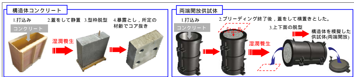
図 - 1 構造体コンクリートと両端開放概要図
