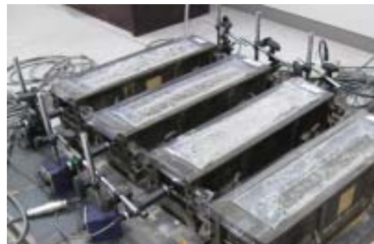
写真 - 1 JCI 法による自己収縮の測定状況 (凝結の始発より材齢 7 日まで)
