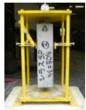
図 - 1 自由膨張供試体およびひずみ測定方法
