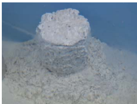
写真-2 硫酸浸漬試験中の様子
