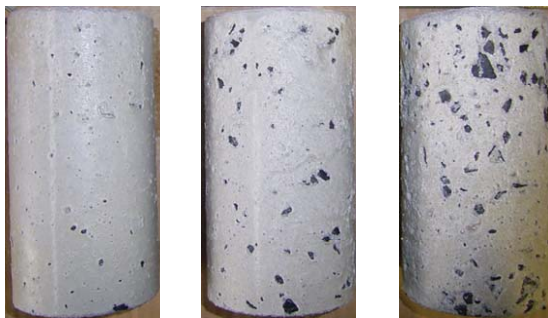
写真-12 種々の粗骨材を用いたコンクリートの硫酸浸漬後の断面および表面
