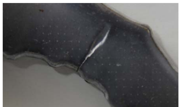
写真-4 Type1 の亀裂発生状況
