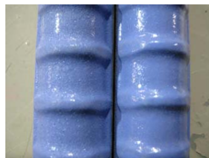
写真-1 エポキシ樹脂塗装鉄筋の外観 (左：高付着型，右：普通)
