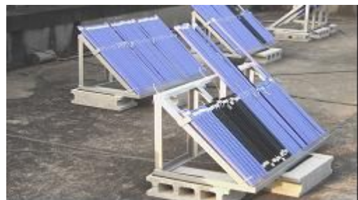
写真-4 鉄筋曝露状況
