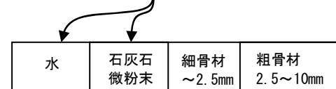
(b) 細骨材の 0.3mm 以下をペーストとして配分する場合
