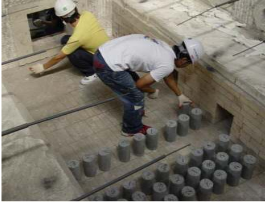
写真-2 加熱炉内部の試験体配置状況
