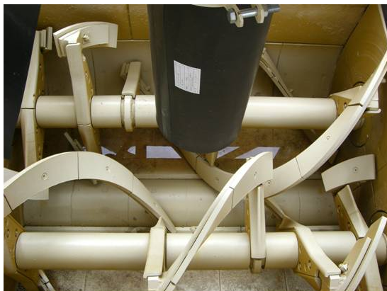
写真-9 新タイプ実機ミキサ(練混ぜ容量 1.67m 3 )
