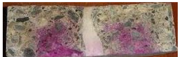
写真-4 ひび割れ幅0.042mmの中性化状況
