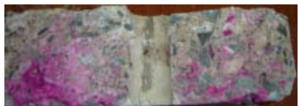
写真-2 ひび割れ幅0.075mmの中酸化状況
