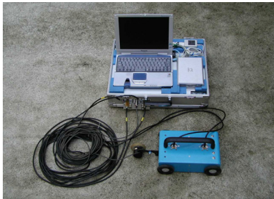
写真-3 電磁波レーダ計測システム
