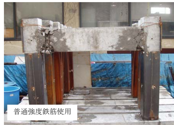
写真—1 高強度 RC 造骨組の破壊状況例 1)
