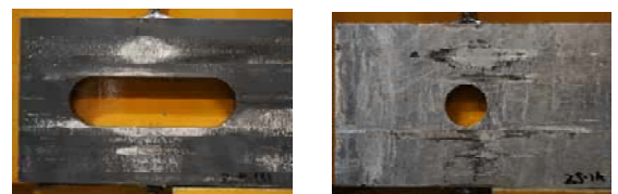
写真-2 Zn-1試験体の鋼材摩擦面(実験後)
