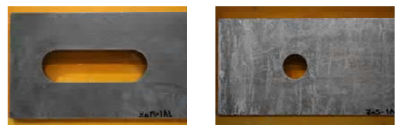
写真-1 Zn-1試験体の鋼材摩擦面(実験前)
