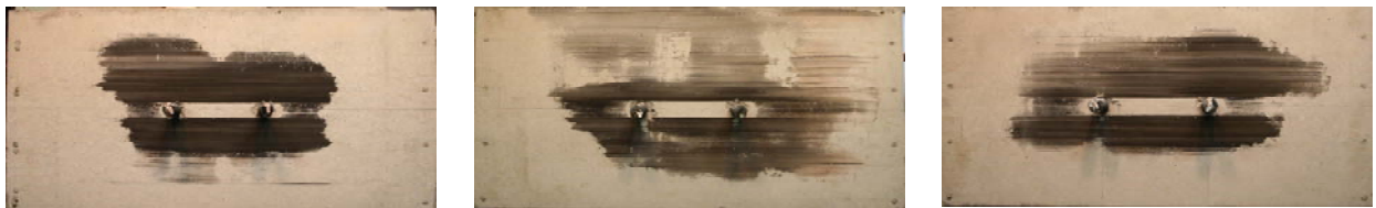
写真-3 PC鋼棒を使用した試験体の加振終了後のコンクリート摩擦面(左から、19P, 21P, 23P試験体)
