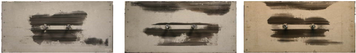
写真-4 普通ボルトを使用した試験体の加振終了後のコンクリート摩擦面(左から、M20、M22、M24試験体)
