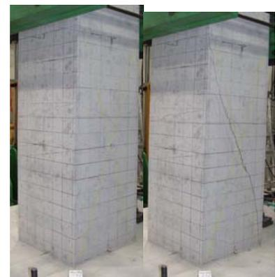
P<sub>max</sub> 時(1δ<sub>y</sub>) P<sub>y</sub> 低下時(2δ<sub>y</sub>)
