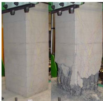
P<sub>max</sub> 時(4δ<sub>y</sub>) P<sub>y</sub> 低下時(8δ<sub>y</sub>)
