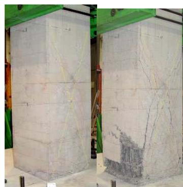
P<sub>max</sub> 時(3δ<sub>y</sub>) P<sub>y</sub> 低下時(6δ<sub>y</sub>)
