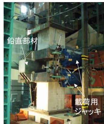
写真-1 No.1~3 荷重状況
