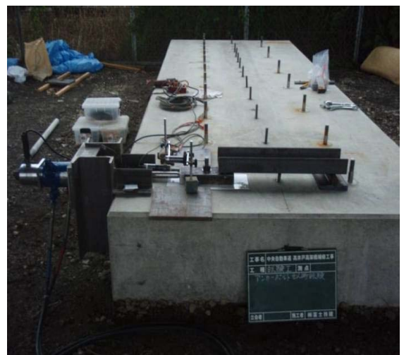
写真-1 載荷試験の実施状況
