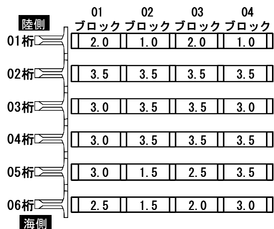
図-3 解体前に実施した健全度調査結果
