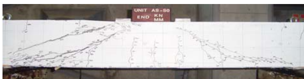
写真-9 破壊状況 (AS-S0)
