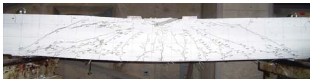
写真-7 破壊状況 (ASN-S1)
