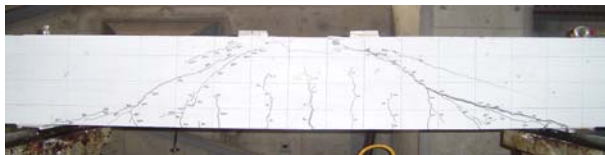
写真-8 破壊状況 (NB-S0)
