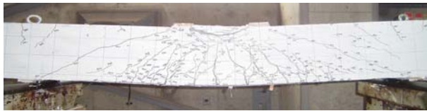
写真-4 破壊状況 (ASN-F)
