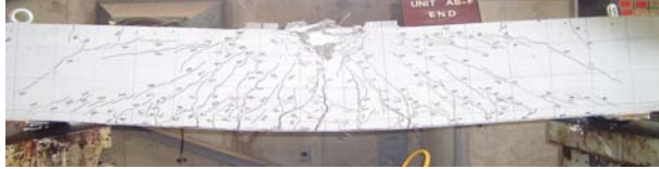
写真-3 破壊状況 (AS-F)
