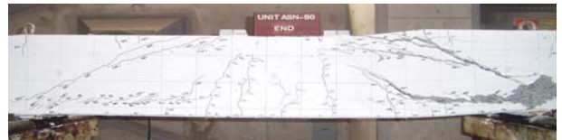
写真-10 破壊状況 (ASN-S0)
