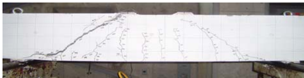
写真-5 破壊状況 (NB-S1)
