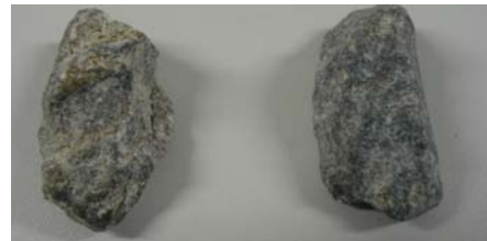
写真-2 磨砕処理前後における粗骨材の一例 (左側：処理前、右側：処理後)
