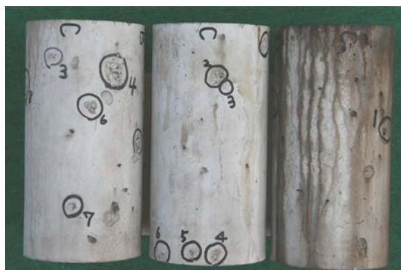
写真-1 PO 発生状況(W/C=40%,生石灰添加率 0.02%)
