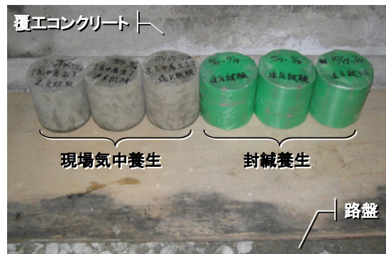
図-11 透気性試験供試体の養生状況
