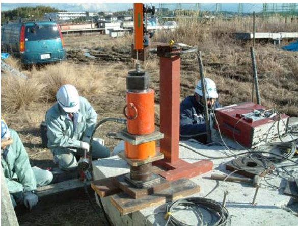
写真-2 付着強度試験の実施状況
