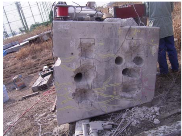
写真-3 スターラップひずみ測定状況
