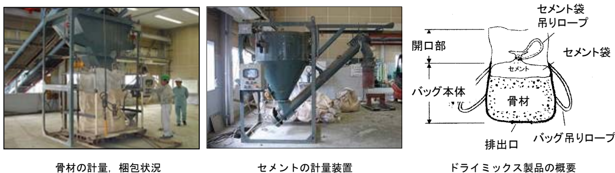
図ー２ ドライミックス製品の製造工程と概要
