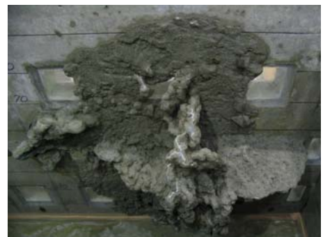
写真-6 埋戻し地盤を考慮した注入試験(ケース4)
