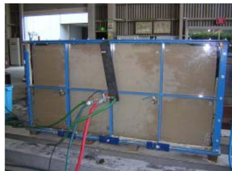
写真-2 注入開始後 5 分が経過した注入試験(ケース1)
