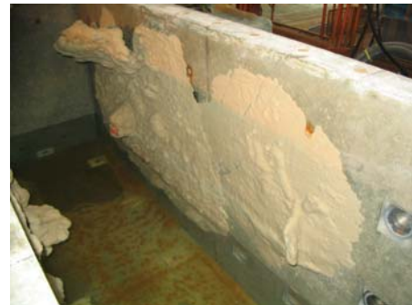
写真-4 コンクリート製土槽を用いた注入試験(ケース2)
