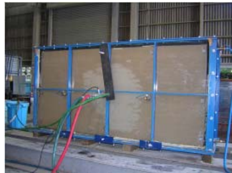
写真-1 注入開始後 1 分が経過した注入試験(ケース1)
