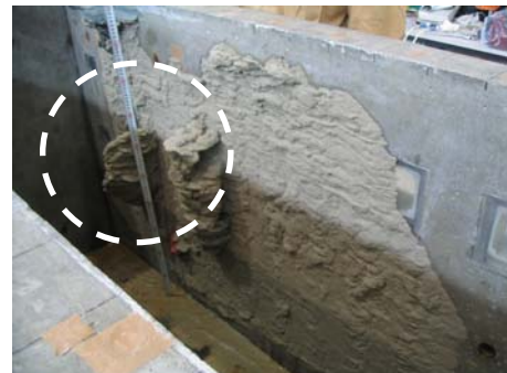
写真-5 土水圧を考慮した注入試験(ケース3)
