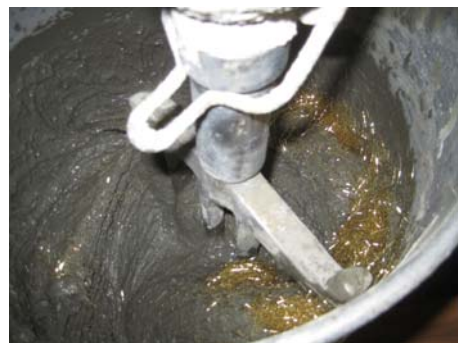
写真-3 高強度高じん性材料の練混ぜ状況
