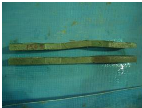
写真-4 凍結融解試験後のダンベル型供試体
