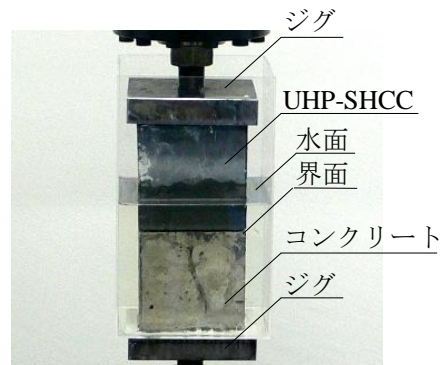
写真-4 荷重状況（水中試験）
