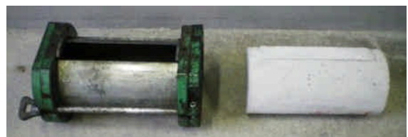
写真-1 φ100mm 横打ち鋼製型枠と供試体
