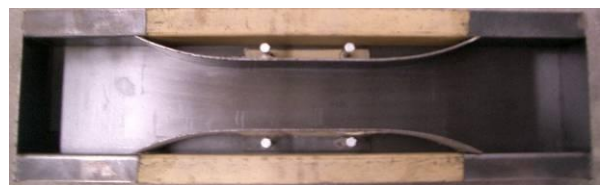
写真-2 試験専用型枠
