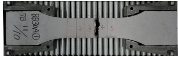
写真-3 供試体破断状況
