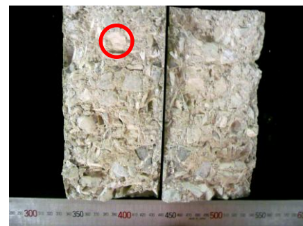
写真-6 石灰石骨材を用いた水セメント比 30%の供試体の破壊面(600℃)
