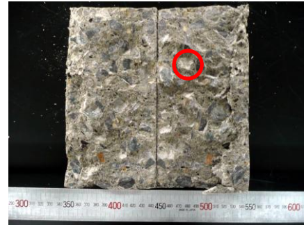
写真-3 普通骨材を用いた水セメント比 50%の供試体の破壊面(常温)
