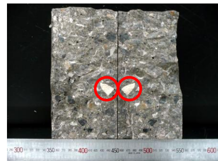
写真-5 石灰石骨材を用いた水セメント比 30%の供試体の破壊面(常温)
