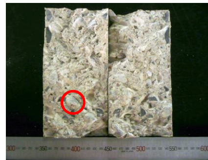
写真-4 普通骨材を用いた水セメント比 50%の供試体の破壊面(600℃)
