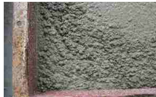
(b) スパイラル型内部振動機を逆転させた場合
