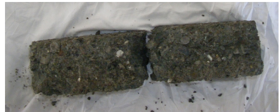
写真-3 基本配合 試験サイクル 150 回
