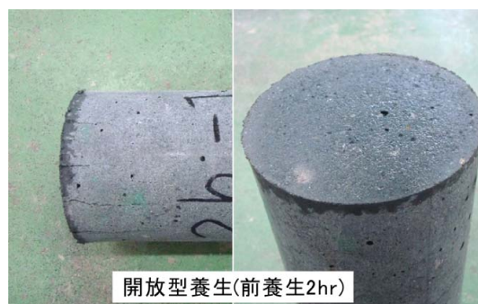
写真-4 供試体の破壊状況 (養生条件の影響)
