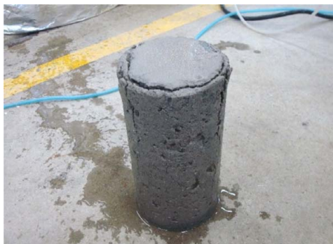
写真-1 高温水中養生時の供試体の膨張破壊
