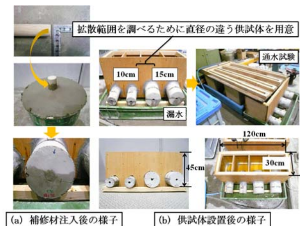
図-4 自己治癒成分を有する補修材の通水試験
