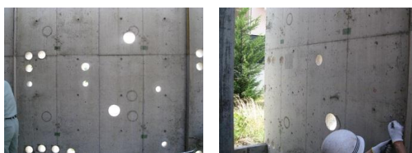
写真-2 実大模擬壁部材 (左: 21N/mm 2 , 右: 27N/mm 2 )
