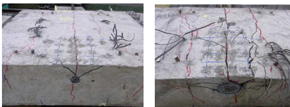
写真-2 破壊時の様子（左：S8, 右：T15）
