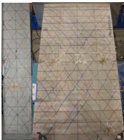
図-22 最大耐力時損傷状況 ねじり卓越 (No. 4, ctc60)
