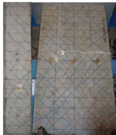
図-23 最大耐力時損傷状況 ねじり卓越 (No. 5, 主鉄筋 5 割増)
