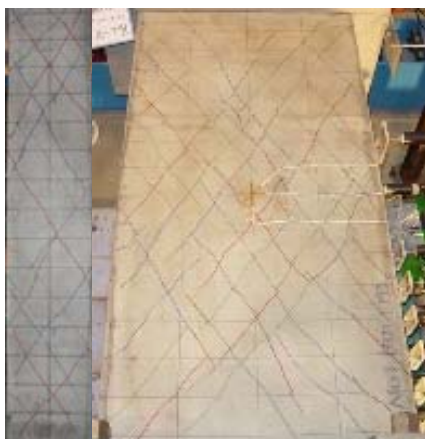
図-19 最大耐力時損傷状況 純ねじり (No. 1, ctc60)
