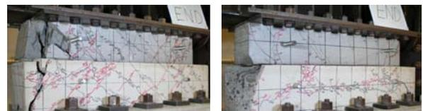
(a) 接着系アンカー (No. 10) (b) 金属系アンカー (No. 16)
