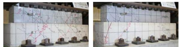
(a) 接着系アンカー (No. 10) (b) 金属系アンカー (No. 16)
