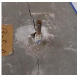
写真-4 割裂破壊
