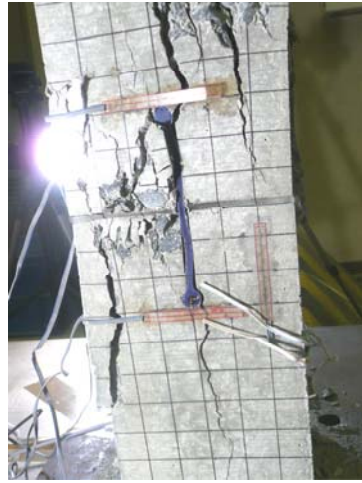
写真 - 7 供試体 1 の試験後の破損状況
