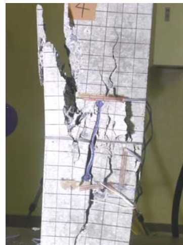
写真 - 13 供試体 4 の試験後の破損状況
