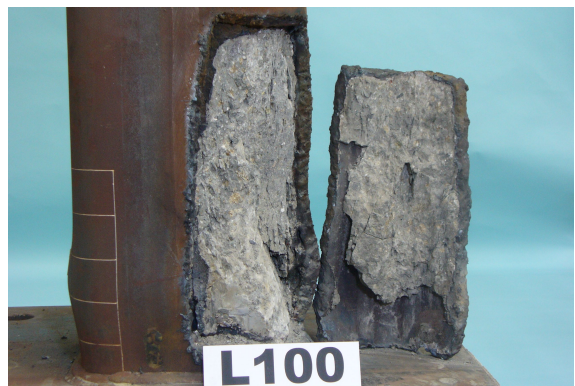
図 - 9 実験終了後の内部コンクリートの様子 (L100)
