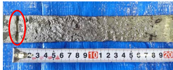
(b) 内部腐食: PI1 (質量減少率: 24%)
